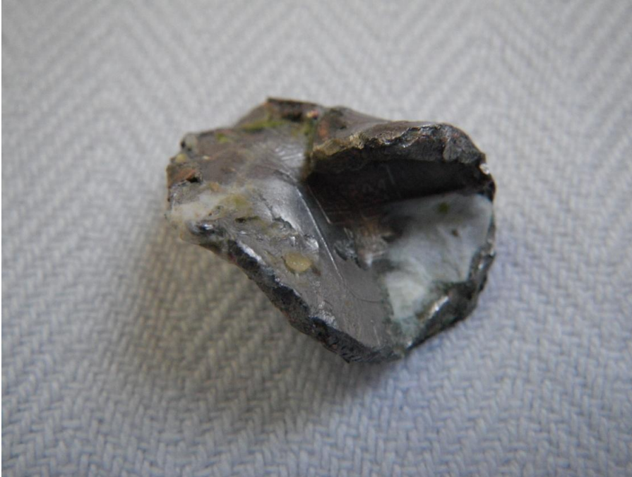
Figur 8. Enkrona som hamnat i matavfallskvarnen under teststillfället. Foto: Ulf Nordberg
